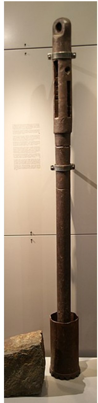
Der mannshohe Eisenbohrer, mit dem Agassiz bis zu 7,5 m tiefe Löcher zur Temperaturmessung in den Unteraargletscher trieb.
